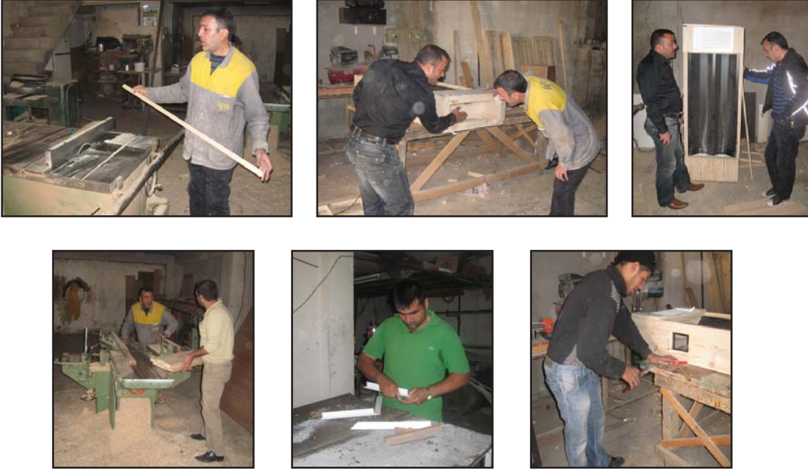
Fotoğraf 2 Tromb Duvarın Yapım Aşamaları
